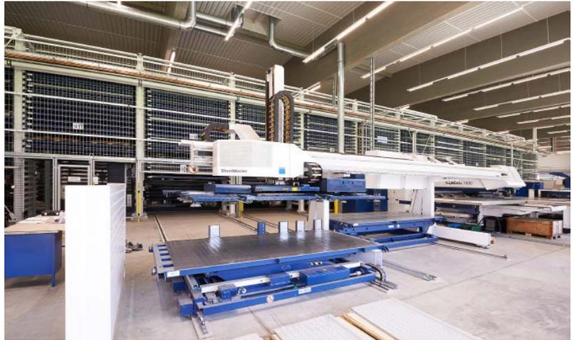
Da die Trumpf Stanzmaschine Trupunch 5000 über eine Tandemstation an das Lager angebunden ist, lagert das RBG jeweils eine mit Tafeln beladene Flachpalette hauptzeitparallel vor, während die Maschine noch Bleche von einer anderen Palette stanz
